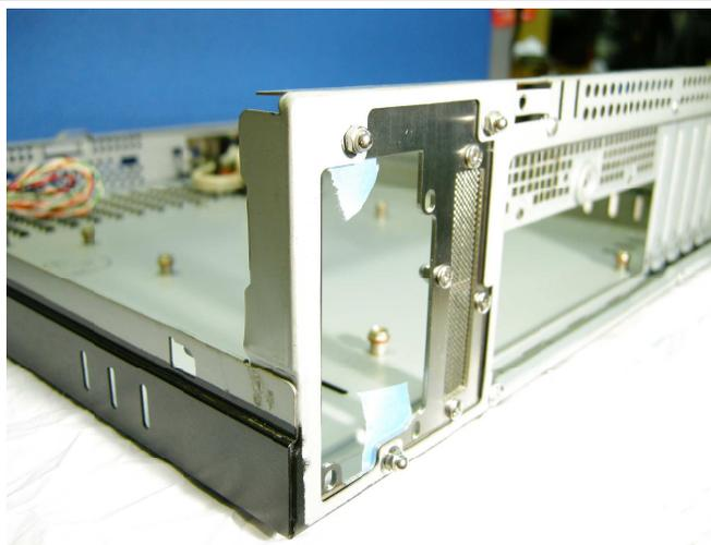
Step. 2b シャーシ内側から取付け付属の袋ナットで固定します。(手締めでOK)
