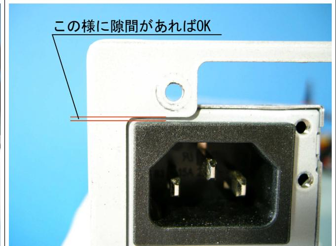
Step. 1b補 インレット上部の隙間を確認する。干渉しないのが確認できたらねじを抜いて次へ。
