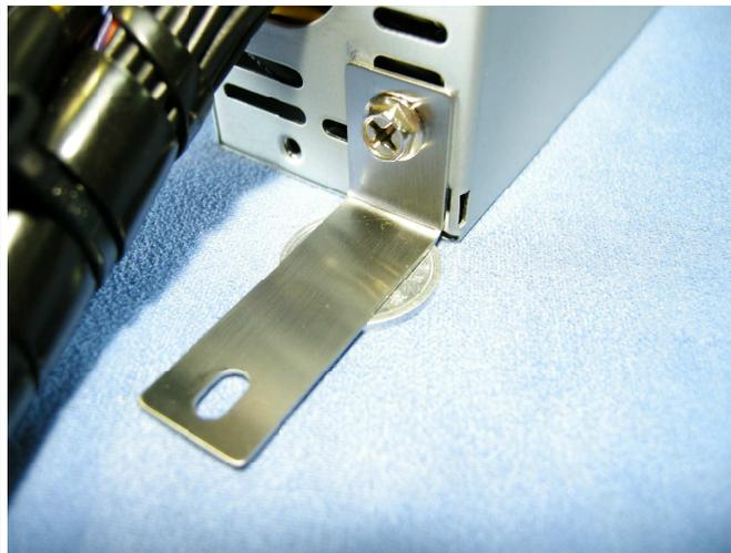
Step. 3 1円玉を治具にしてサポートをインチねじで固定します。
