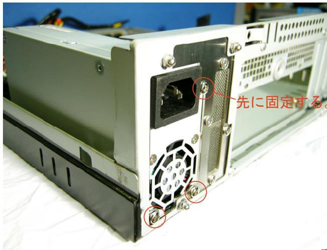
Step. 4a ブラケットに付属のインチねじで電源を固定します。
