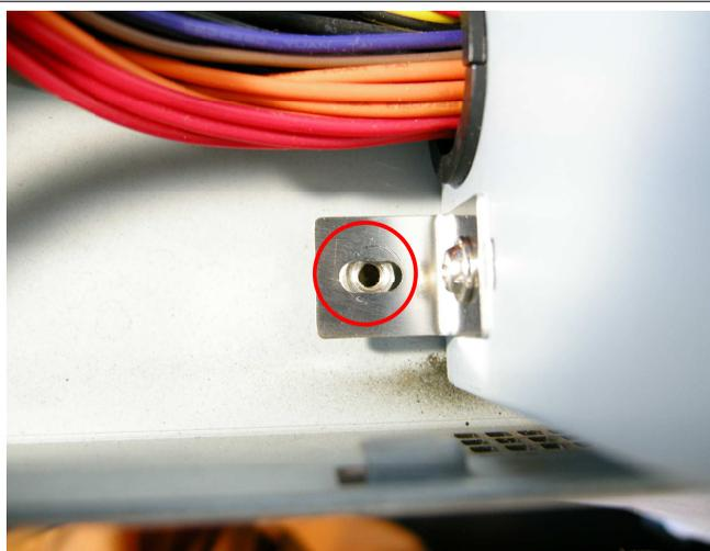
Step. 4b サポートとシャーシの穴位置を確認してOKなら次へ、ずれている場合は各ねじを緩め調整
