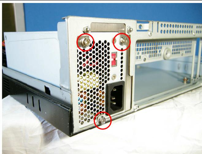
Step. 4a 電源付属のインチねじでブラケットに電源を軽く固定します。
