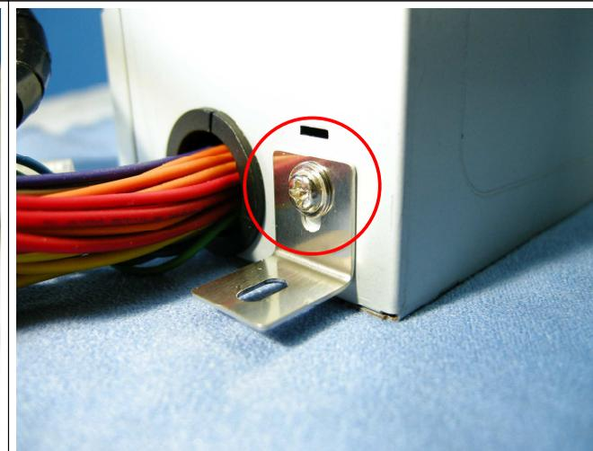
Step. 3 サポートを電源に取付ける。純正電源はM3ワッシャーねじ、TFX電源はインチねじで固定。
