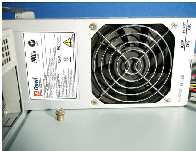
Step. 1a ブラケットを取付ける前に画像のように電源をベタ置きし仮合わせする。
