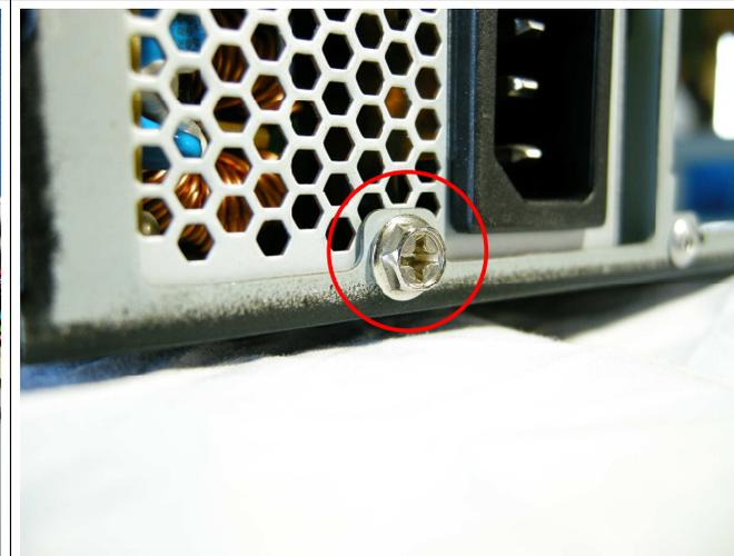
Step. 1b 画像の場所を電源付属のインチねじで締める。奥まで締まるのを確認後、電源は取り外す。
